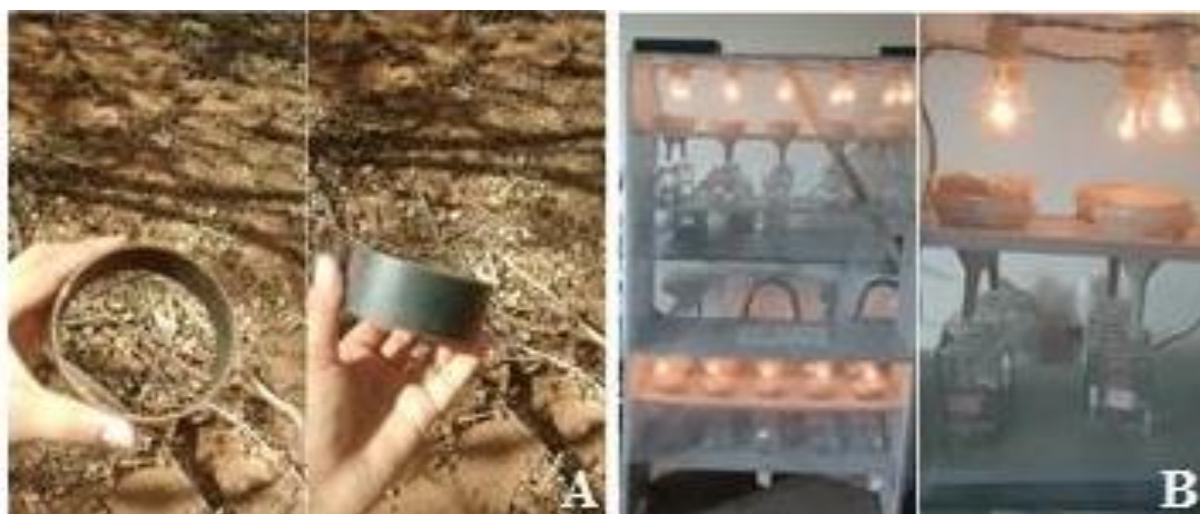
Figura 3- Os anéis para coleta do solo (A) e o extrator Berlese-Tullgren modificado contendo recipientes de vidro e garrafas PET com 30 ml de solução de álcool etílico 70% (B).
